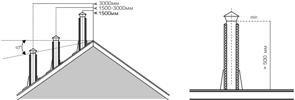
1. Не менее 500 мм над коньком кровли или парапетом, при расположении трубы на расстоянии до 1,5 м от конька или парапета.
