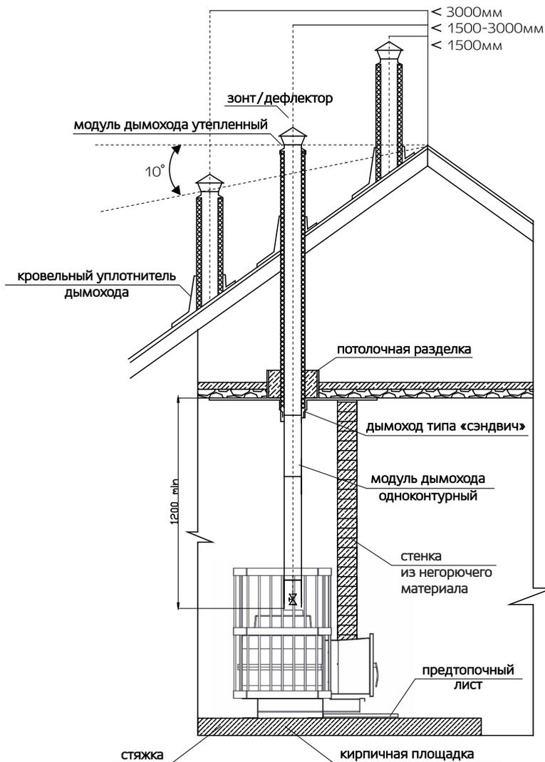
Рис. 17 Схема установки печи «Сибирь», вид сбоку
