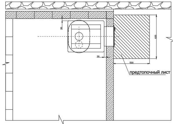
Рис. 18 Схема установки печи «Сибирь», вид сверху
