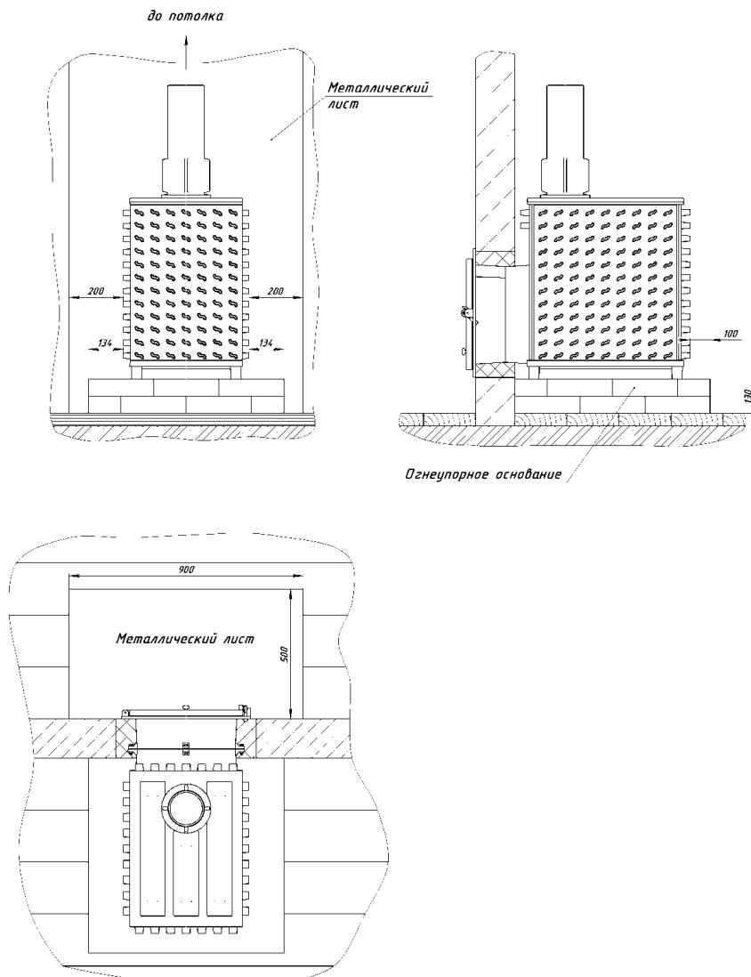
**Рис.3 – Монтаж печи**
